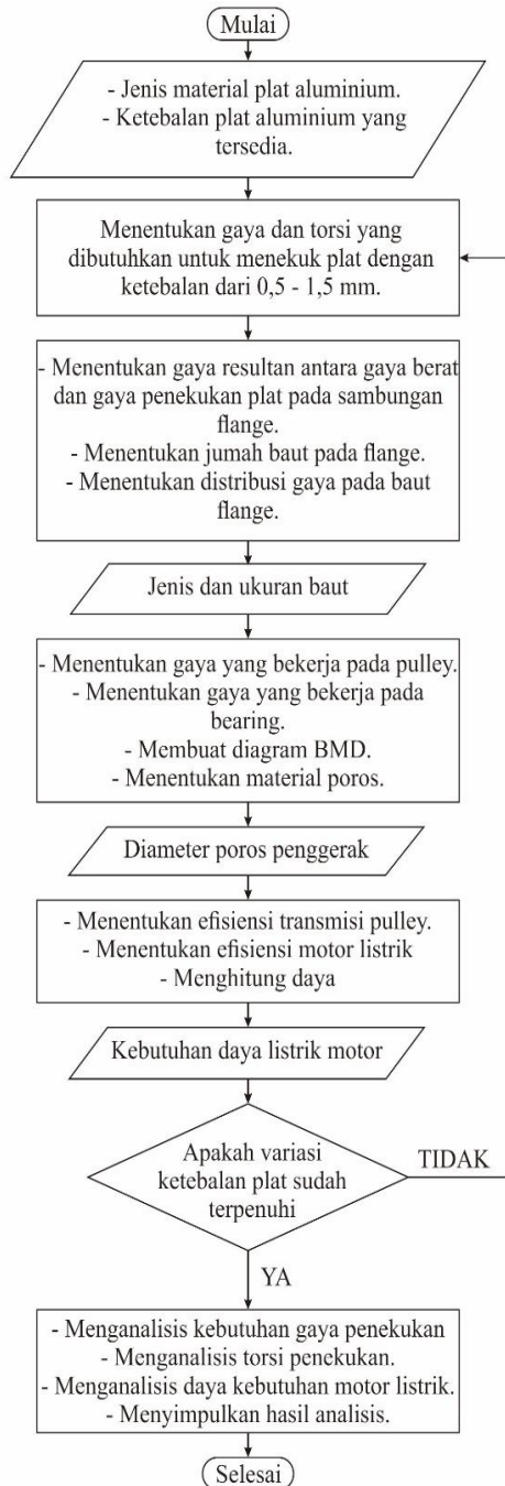
Gambar 2. Alur perancangan mesin roller spinning
