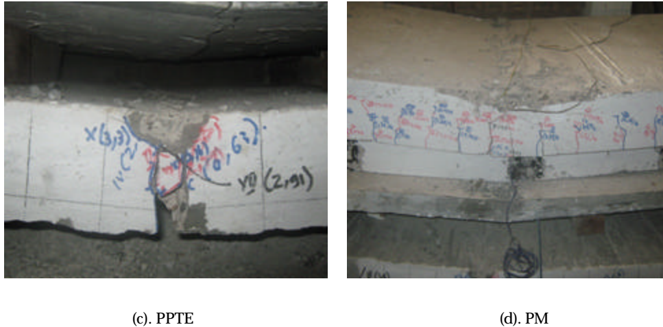
GAMBAR 6. Pola retak benda uji
