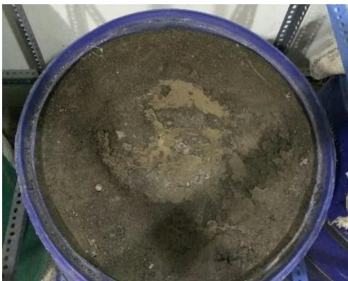
Gambar 1 Kondisi tanah lempung ekspansif dalam drum percobaan.
