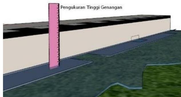
Gambar 5 Cara mengukur lebar dan tinggi genangan
