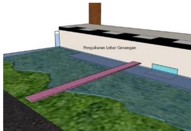
Gambar 6 Cara mengukur lebar dan tinggi genangan
