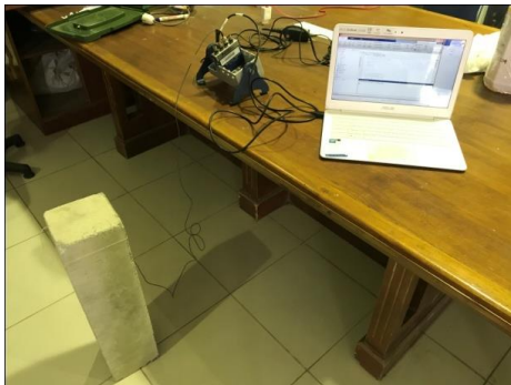
Gambar 4. Proses uji daya redam beton
