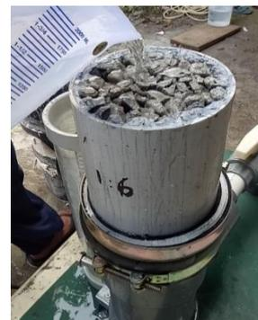
Gambar 4. Pengujian infiltrasi beton porous
