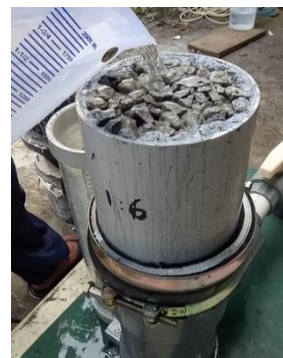
Gambar 4. Pengujian infiltrasi beton porous
