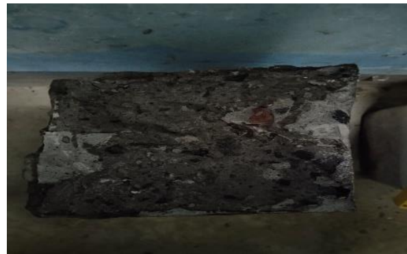
Gambar 9 Cairan Epoxy mampu melekat dan mengisi Celah-celah Beton
