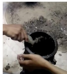
Gambar 7 Adukan beton dimasukkan ke dalam benda uji silinder
