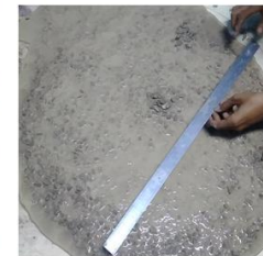
Gambar 6 Hasil uji slump
