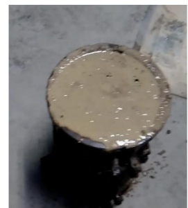
Gambar 7 Adukan beton dimasukkan ke dalam benda uji silinder
