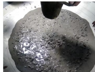
Gambar 6 Hasil uji slump
