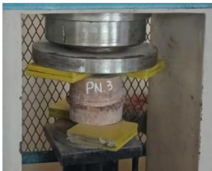
Gambar 3. Pengujian Kuat geser Bambu
