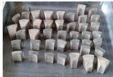
Gambar 2. Spesimen pada pengujian kadar air dan kerapatan Bambu Petung
