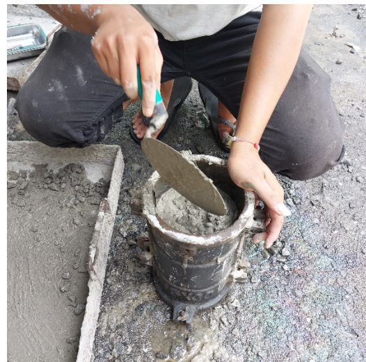
Gambar 6. Pembuatan benda uji silinder beton
