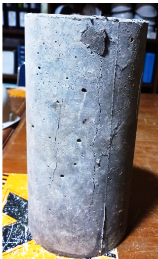
Gambar 12. Keruntuhan benda uji campuran serbuk karet 10%
