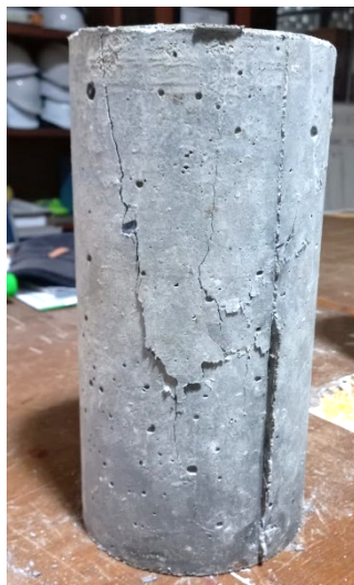
Gambar 11. Keruntuhan benda uji campuran serbuk karet 5%
