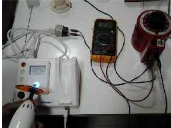
**Gambar 1. Pengaturan intensitas sinar halogen**
