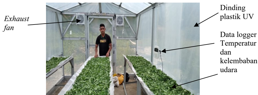
GAMBAR 1. Rumah pengering daun kelor yang dilengkapi dua buah exhaust fan dengan beban pengeringan pada tiga buah rak jemur.
