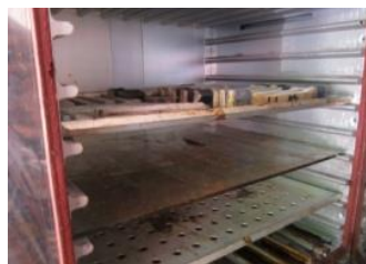
Gambar 5. Spesimen uji komposit dipanaskan dalam oven listrik
