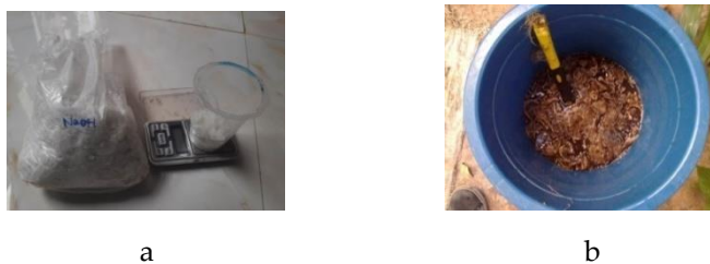
Gambar 2. (a) penimbangan NaOH, (b) perlakuan perendaman NaOH pada serat
