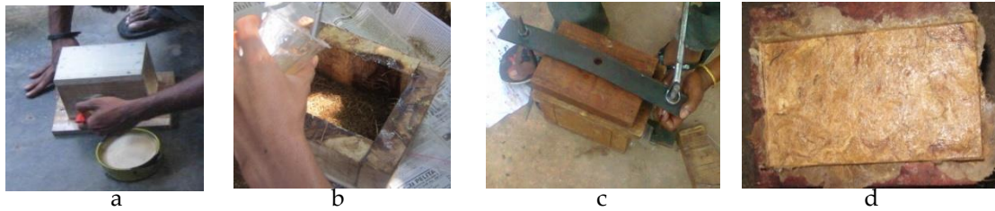
Gambar 3. (a) cetakan diberi wax mirror glass , (b) proses cetak hand ly up , (c) cetakan yang dipres, dan (d) komposit hasil cetakan
