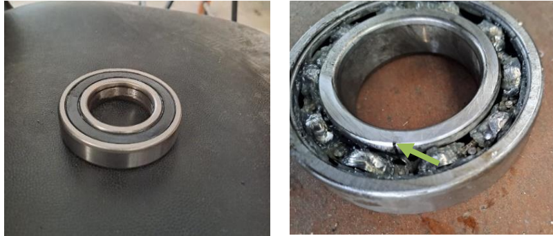
Gambar 2. a) Bantalan Normal, (b) Bantalan Cacat Lintasan Dalam
