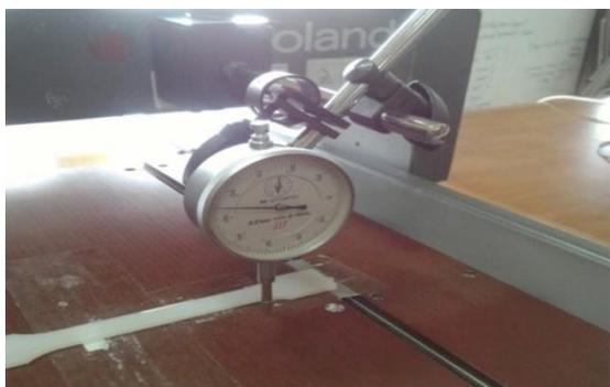
Gambar 14. Pengukuran *near gate* dan *far gate*
