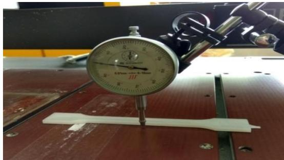
Gambar 13. Pengukuran *transversal*
