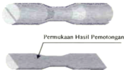
Gambar 7. Pemotongan spesimen uji strukturmikro dan kekerasan
