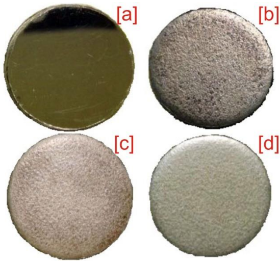
Gambar 3. [a] Tanpa perlakuan shot peening , perlakuan shot peening diameter steel ball [b] 0,4 mm, [c] 0,6 mm, [d] 0,7 mm.
