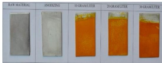
Gambar 3.2 Hasil anodizing menggunakan variasi konsentrasi pewarna kunyit
