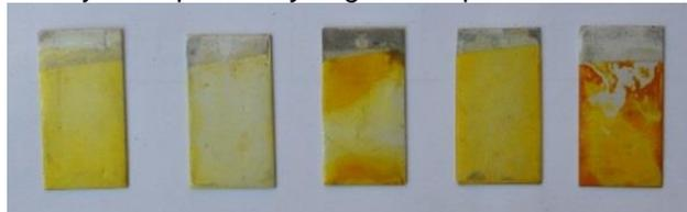
Gambar 3.1 Kegagalan dari proses *dyeing* pada proses anodizing
