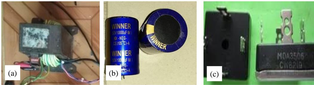
Gambar 3.1. (a) Transformator (b) Kapasitor, (c) diode bridge yang digunakan pada power supply
