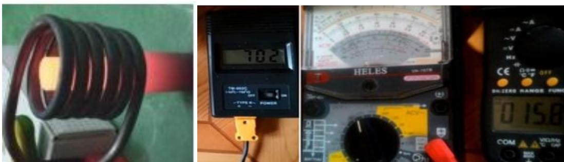
Gambar 2.3. Pengukuran temperatur dan arus pada pengujian mesin *preheat*
