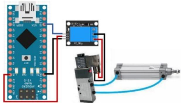
Fig. 12. Pneumatic pin circuits
