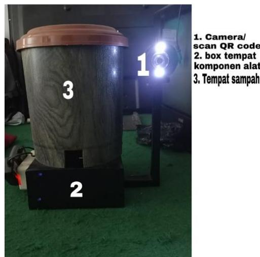
Gambar 6. Hasil Perancangan Dari Prototype Tempat Sampah
