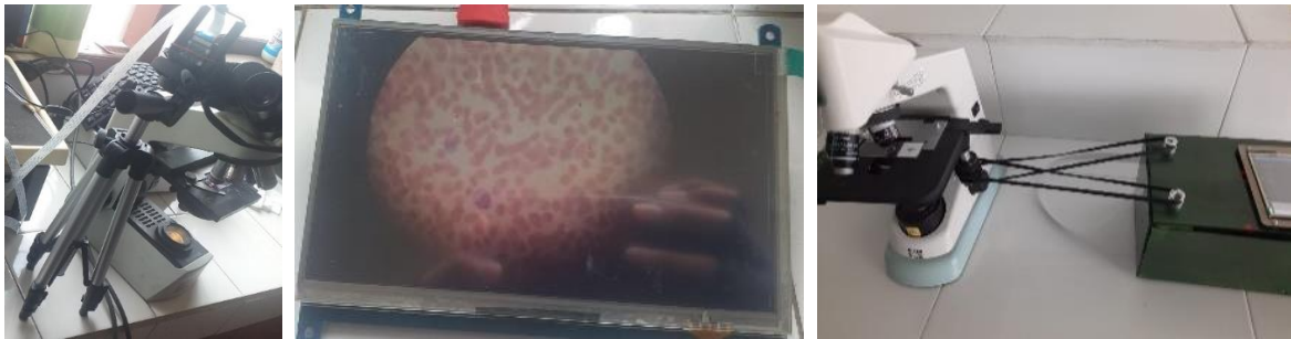
Gambar 4. Rangkaian Mikroskop dengan Input Sampel Sel Darah Merah Terhubung Dengan Kamera Digital, Komputer Mini, dan Layar LCD Dimana Terlihat Citra Hasil Perbesarannya. Komponen Driver Motor dan Motor Stepper Juga Digunakan untuk Memutar Dua Tuas Untuk Menggeser Meja Preparat Secara Horizontal dan Vertikal Secara Otomatis yang Juga Dilengkapi Dengan Catu Daya DC
