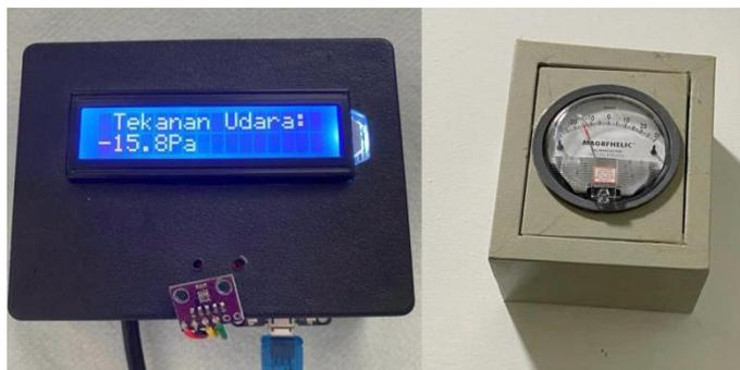
Gambar 7. Pengukuran Tekanan Udara
