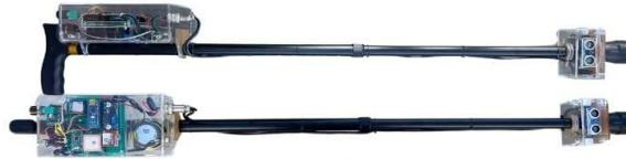
Gambar 4. Rancang Bangun Tongkat Tunanetra berbasis *Internet of Things* dilengkapi *Headset*
