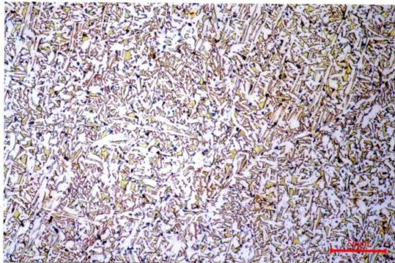
GAMBAR 4. Struktur Mikro pada Variasi Suhu 500 °C
