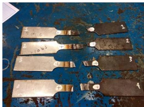
GAMBAR 5. Spesimen setelah uji tarik
