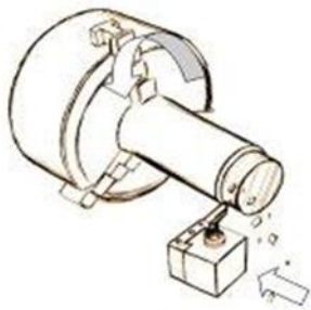
GAMBAR 1. Prinsip proses pembubutan (Amstead, 1981)
