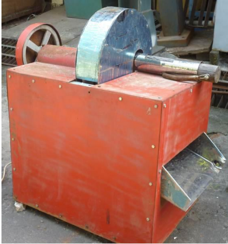
GAMBAR 10. Mesin perajang singkong dengan pendorong pegas
