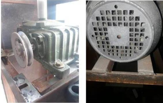
GAMBAR 6. Gearbox, poros, pulley (kiri) dan motor listrik AC (kanan)
