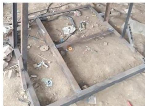
GAMBAR 5. Rangka dudukan alat PSJ (Pengolah Serbuk Jahe)
