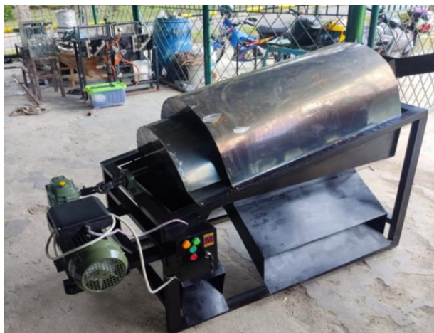
Gambar 2. Mesin pengayak pasir sistem rotary dengan tiga grade hasil ayakan
