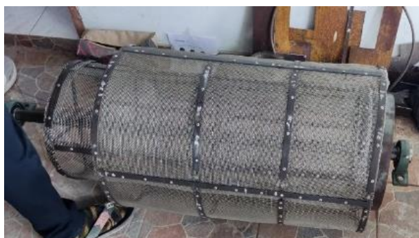
Gambar 3. Tabung saringan pengayak pasir
