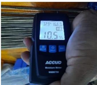
Gambar 6. Pengukuran kadar air lidi sawit kering dari UMKM
