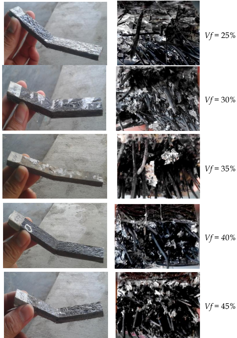
GAMBAR 5. Foto makro patahan dan penampang patahan hasil pengujian bending
