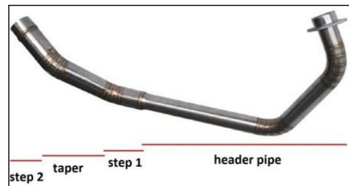
Gambar 4. Desain dan Ukuran Muffler
