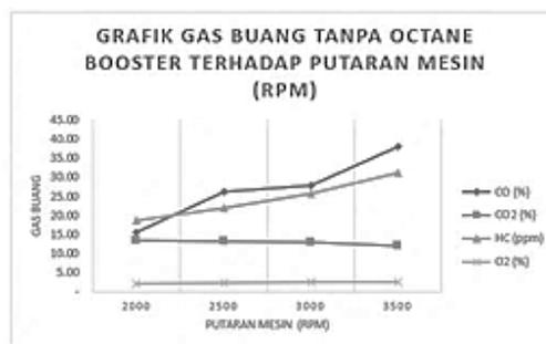
GAMBAR 2. Hasil pengujian emisi gas tanpa octane booster
