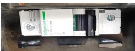
GAMBAR 2. MCB sepeda motor listrik
