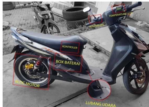
GAMBAR 6. Sepeda motor listrik hasil konversi
