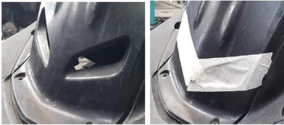
GAMBAR 4. Pengujian saluran ventilasi udara terbuka (kiri) dan saluran ventilasi udara tertutup (kanan)
