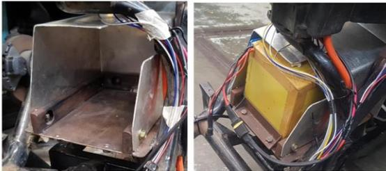
GAMBAR 1. Box baterai sepeda motor listrik
