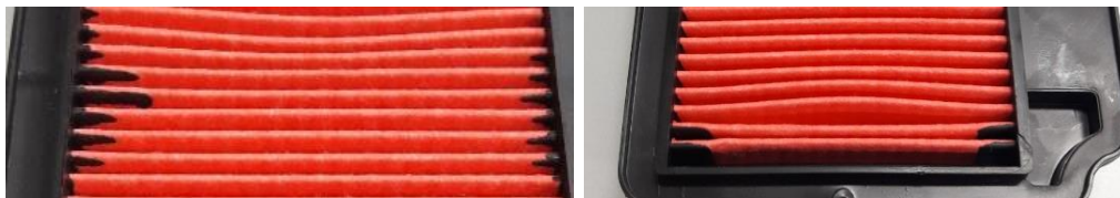
GAMBAR 3. Flash pada hasil trial
