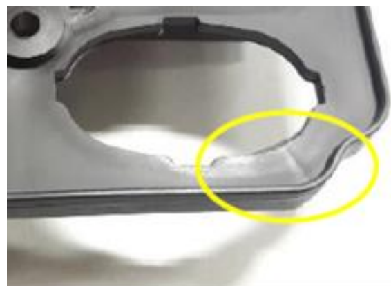
GAMBAR 9. Weld line pada hasil trial
