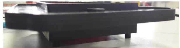
GAMBAR 13. Sink mark pada hasil trial
