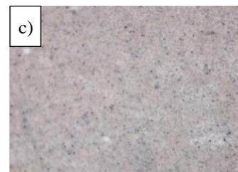
GAMBAR 3. Struktur mikro hasil pengelasan pada daerah *weld line* dengan sudut chamfer a) 15°, b) 30° dan c) 45°.
