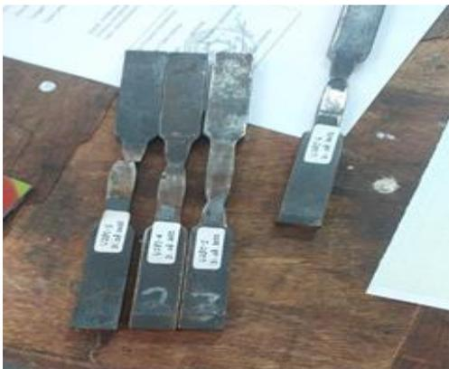
GAMBAR 2. Hasil patahan spesimen setelah dilakukan uji tarik
