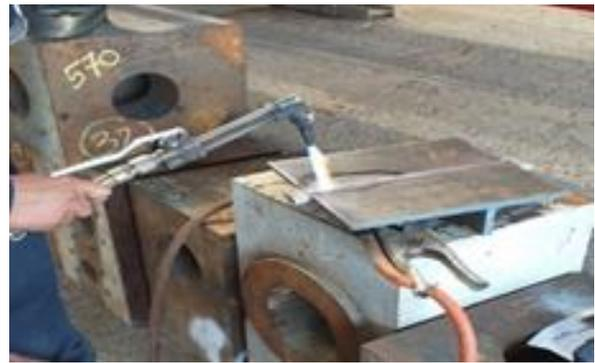
GAMBAR 1. Proses preheating pada spesimen
