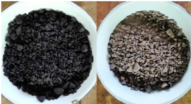
Gambar 3. Pengujian Ekstraksi CPHMA-Sebelum dan Sesudah Ekstraksi
