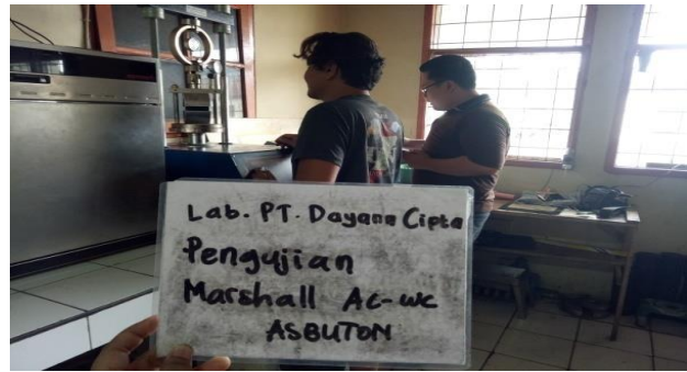
Gambar 4. Pengujian Marshall AC-WC Asbuton di Lab. PT. Dayana Cipta
