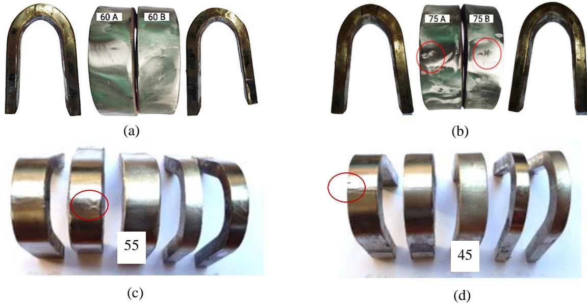
Gambar 11. Foto spesimen root bend (a) dan side bend (b) setelah dilakukan pengujian bending
