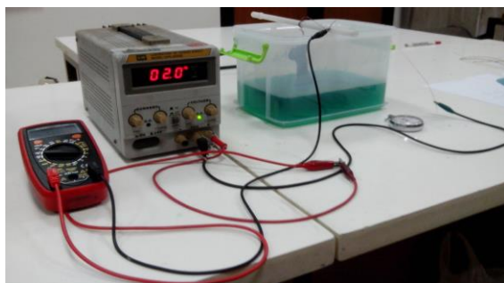
GAMBAR 5. Alat yang digunakan dalam proses electroplating Ni-Cr
