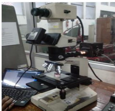
GAMBAR 9. Mikroskop optik untuk uji ketebalan lapisan Ni-Cr
