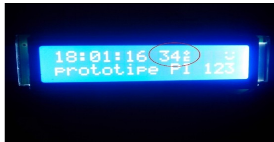
GAMBAR 11. hasil tampilan sensor suhu
