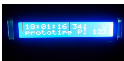
GAMBAR 8. Pembacaan data DS1307 pada lcd
