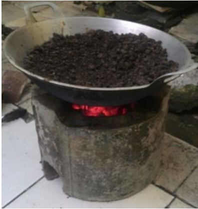
GAMBAR 4. Tungku dan wajan untuk pencampuran
