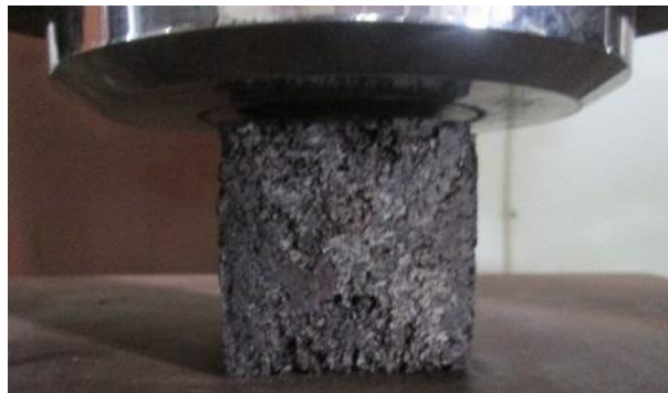
GAMBAR 8. Pengujian kuat tekan sampel
