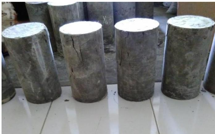
GAMBAR 7. Keruntuhan beton serat setelah diuji tekan
