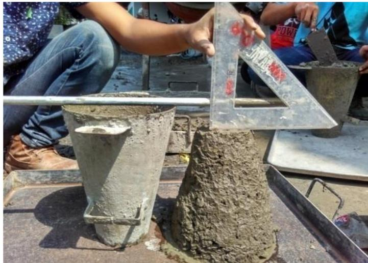
GAMBAR 4. Pengujian *slump* beton segar
