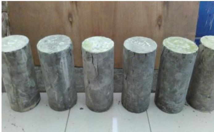
GAMBAR 6. Beton serat umur 28 hari setelah diuji tekan
