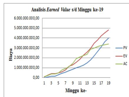
Gambar 6. Analisis *Earned Value* sampai dengan minggu ke-19 Proyek Pembangunan Gedung IGD RSUD Sunan Kalijaga, Demak
