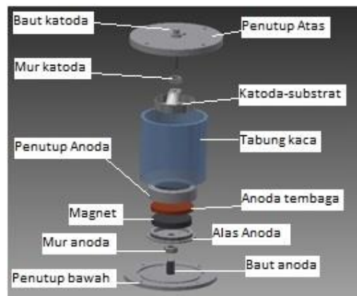
GAMBAR 3. Desain komponen vacuum chamber
