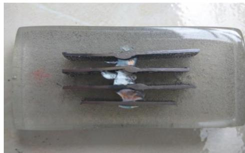
GAMBAR 1. Spesimen uji metalografi
