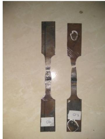
GAMBAR 10. Spesimen hasil uji tarik
