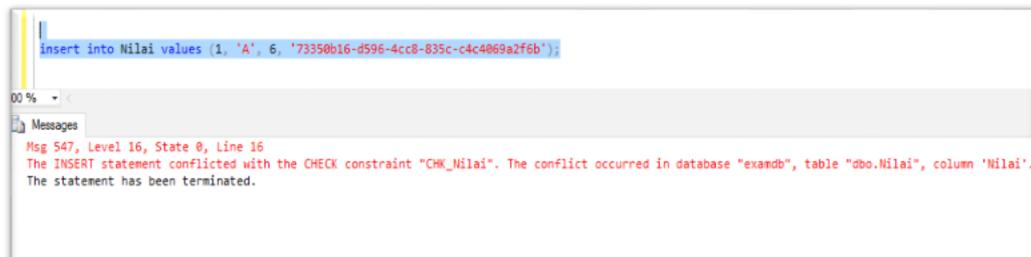
GAMBAR 12. Validasi Check Constraint pada kolom Nilai
