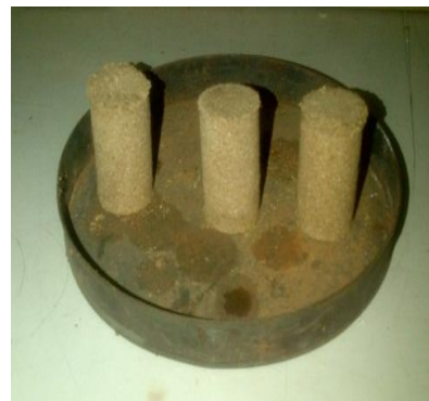
GAMBAR 5. Biobriket dengan bahan penyusun serbuk kayu dan Serabut Kelapa
