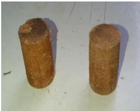
GAMBAR 4. Biobriket setelah dikeringkan
